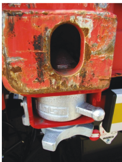
Figura 17: Pestillo giratorio con contenedor
