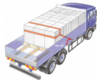
Figura 40: Sujeción con resortes mediante la utilización de una eslinga
